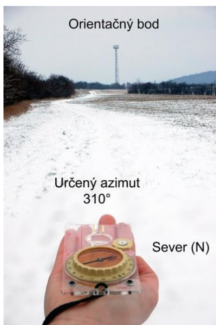
Obrázok 51 Určenie azimutu bodu v teréne ( www.lubosiska.webnode.sk )
