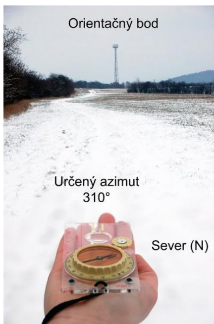
Obr. 4 Určení azimutu bodu v terénu
