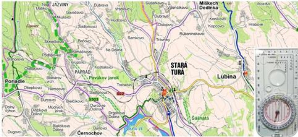
Obr. 5 Orientace mapy pomocí buzoly
